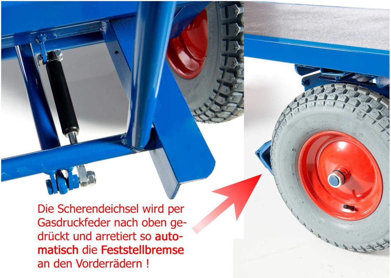
Die Scherendeichsel wird per Gasdruckfeder nach oben gedrückt und arretiert so **automatisch** die **Feststellbremse** an den Vorderrädern !
