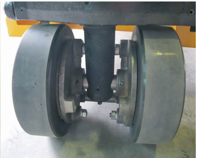
Fahr- und Betriebsbremse montiert am Gabelhubwagen mit Polyurethanrädern
