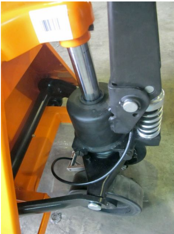
Fahr- und Betriebsbremse montiert am Gabelhubwagen mit Polyurethanrädern
